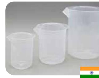
Avec graduation en relief. Autoclavable jusqu'à 121 °C.
