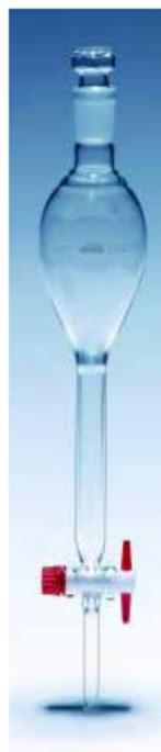
**AMPOULE À DÉCANTER SPHÉRIQUE**
