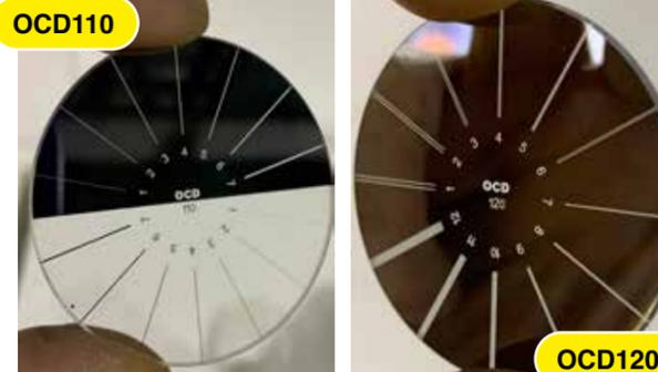
Largeur des fentes : 40, 70, 100 µm. Espacement 100 à 500 µm
