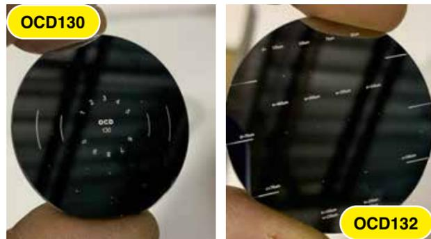
Niveau supérieur : 4 trous Ø150,100,70,50µm
