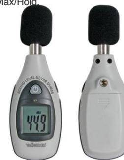
Gamme de mesure de 35 à 135dB adapté aux fréquences de 31,5Hz à 8KHz. Résolution 0,1dB. Mesure rapide. Fonction Min/Max/Hold. Ecran numérique rétroéclairé. Technologie microphone à électret.
